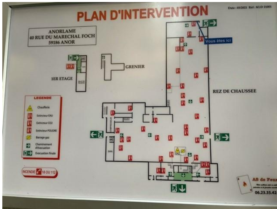
Figure 15 : Localisation de extincteurs
